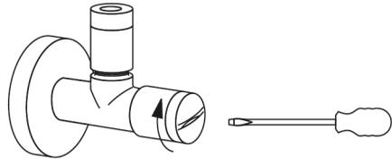
2. Filterkappe mittels Schraubendreher oder Münze im Uhrzeigersinn herausdrehen
