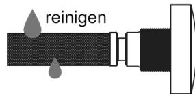
3. Filter entnehmen und unter fließendem Wasser
